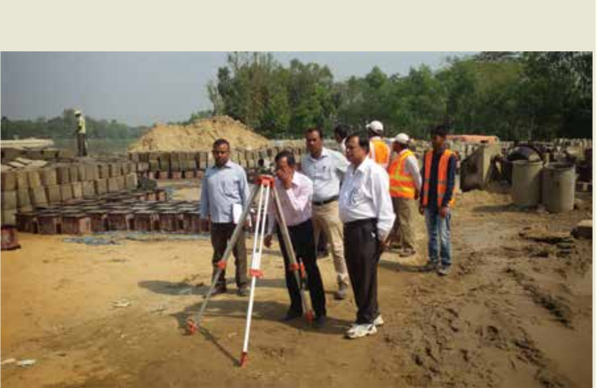
সরকারী রেলপথ পরিদর্শক কর্তৃক লাকসাম চিনকি আস্তানা ডাবল লাইন সেকশনের ব্রীজ নাম্বার ১৮১-এর Card Deflection Test কার্যক্রম পরিদর্শন (২০১৫)।
